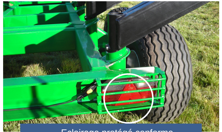
Eclairage protégé conforme
