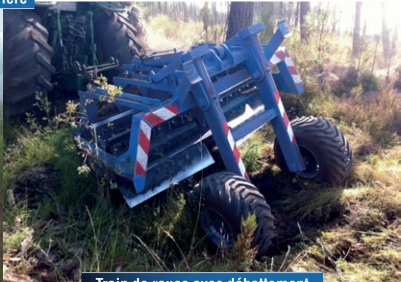
Train de roues avec débattement et bras de levier importants
